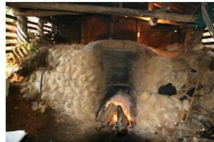
炭の原料は、一般的にコナラやクスギ、アカマツなどですが、木材や竹であればほとんどは炭になるそうです。最近ではバラの花やマツボックリなども装飾用として焼かれています。炭焼き窯に入れられた炭の材料である木材は、燃やさないように酸素を極力遮断して熱を加えられ、温度上昇が進むと木質の成分であるセルローズやリグニンが自分自身で熱を出して分解し炭に変わって行きます。
