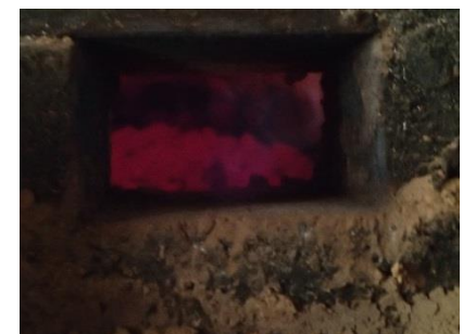
(覗き窓から内部を見たところ。温度が上がって炭化したと思われる炭材が赤くかがやいています。)
