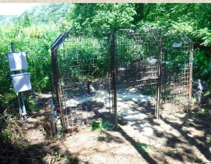
わなの中へ誘引して捕獲する方法は、基本的にはこわなと同じです。囲いわなは複数頭での捕獲が可能です。近年、簡易に移設できる囲いわなやICTゲートなどによる捕獲も行われています。
